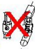
Не открывайте вентиль до тех пор пока не будут затянуты два фиксирующих винта и предохранительная цепь
